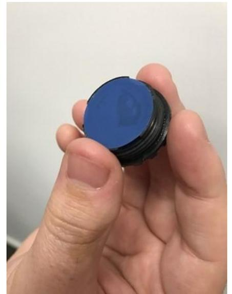
DO NOT SWEEP THE FINGER FROM SIDE-TO-SIDE AS ABRASION MAY DAMAGE THE SENSING LAYER.
